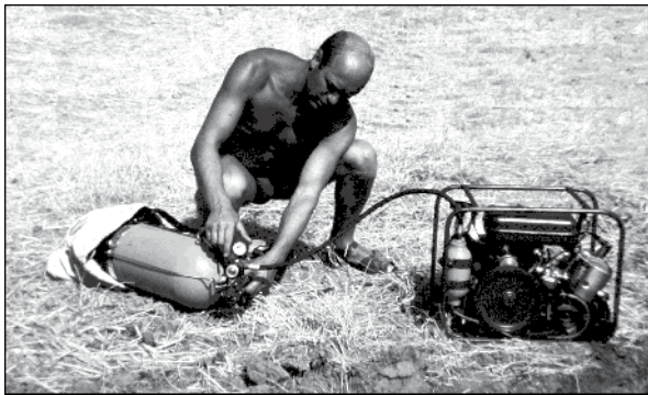
Kompressor AK 150 mit Mopedmotor in Bulgarien.
